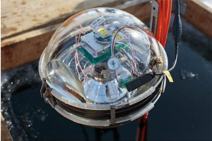
Детектор → 11 кластров → 8 струн → 36 оптических модулей (ОМ)
