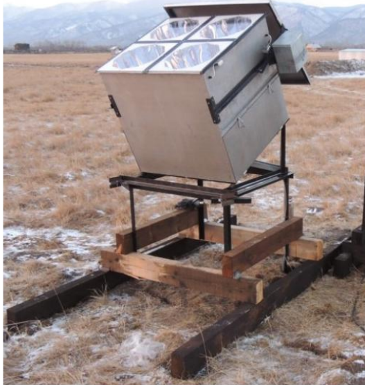
Оптическая станция установки TAIGA-HiSCORE комплекса TAIGA-1
