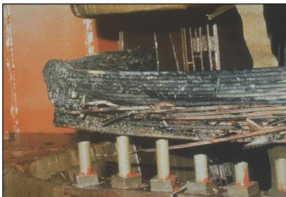
Термическое повреждение силовых трансформаторов вследствие магнитной бури. Провинция Квебек, Канада (13 марта 1989 г.).
